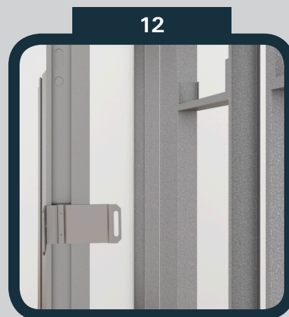
Detail nasazení kotvy zárubně 25/15
