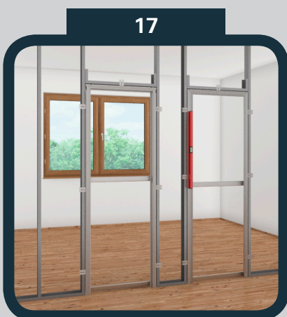
Vyvažte zárubeň vertikálně
