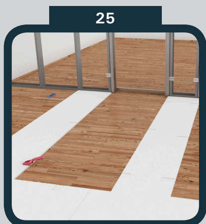
25 Podle obrysu vytvořte zhloubení
