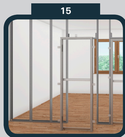
Zárubeň vložte do stavebního otvoru
