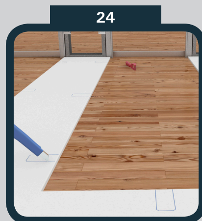
24 Podle obrysu vytvořte zhloubení
